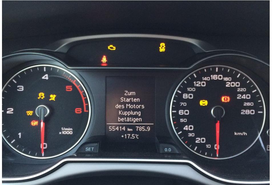
Funktionskontrolle vor dem Motorstart: Wichtige Kontrolllampen leuchten kurzzeitig auf.
